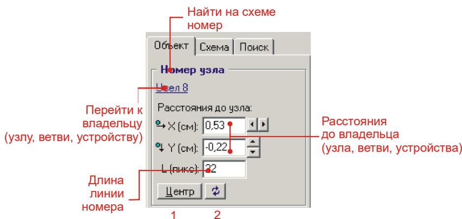
Рис. 4.11. Панель свойств для номера объекта
