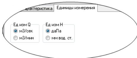
Выбор единиц сразу же отражается на координатах опорных точек в таблице и графике аэродинамической характеристики. Текущие единицы можно увидеть на осях графика.
