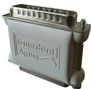
Рис. 1 Ключ Guardant Aptus, подключаемый к порту LPT
